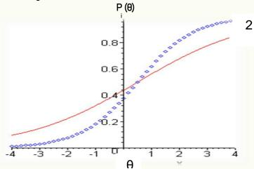
Gambar 1. Kurva Karakteristik Butir Model 2-PL, dengan Butir 1 (a = 0,5; b = 0,5) dan Butir 2 (a = 1; b = 0,5)
